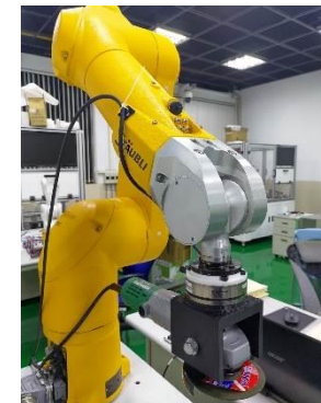
機械手臂不鏽鋼工件研磨拋光
