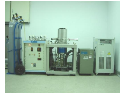
冷凍真空幫浦性能測試與應用
