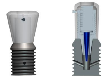
應用於生醫感測(左)與藥物傳遞(右) 之新型牙植體設計 Novel dental implant platform design
