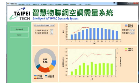
BACnet網路標準之空調能源管理系統
